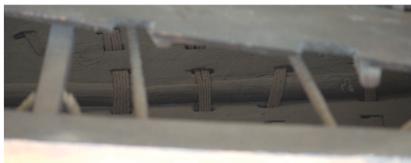
Abb. 11 Zwirn-Verbindungen von Planken und Balken im Schiff König Cheops’.
